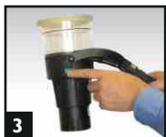
3 Appuyer sur le Commutateur. Placer sur le détecteur.
